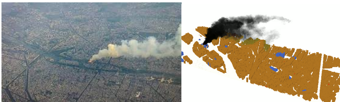
Figure 3. : Comparaison visuelle du panache observé et du panache calculé en proximité de l'incendie pour évaluer le terme source.
